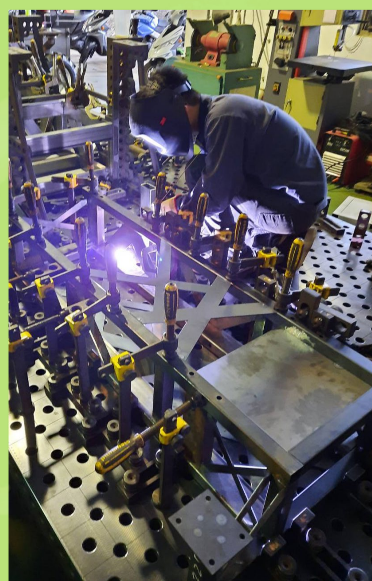
車架結構焊接
